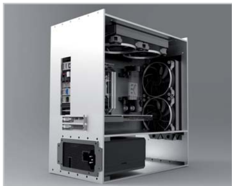
Datorchassi konstruktion skapad i Alibre Design Expert. Foto rendering är gjord med Keyshot.
